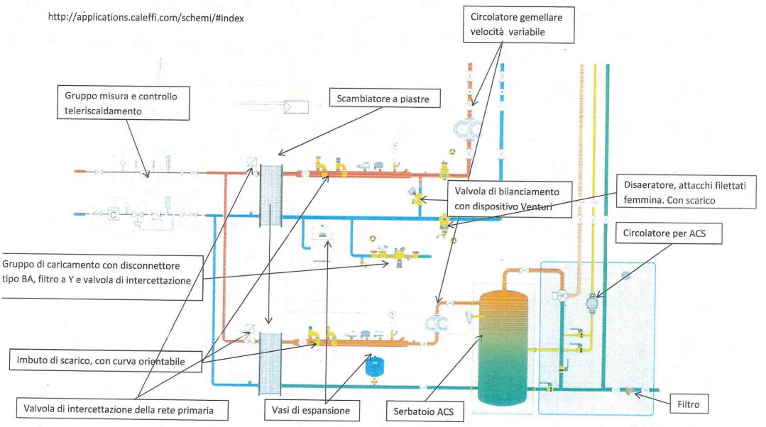
IL CANDIDATO ARGOMENTI RISPETTO ALLO SCHEMA DI CENTRALE TERMICA RAPPRESENTATO DESCRIVENDO LE CARATTERISTICHE DELL'IMPIANTO E I PRINCIPI DI FUNZIONAMENTO PARTENDO DALLE COMPONENTI INDICATE.
